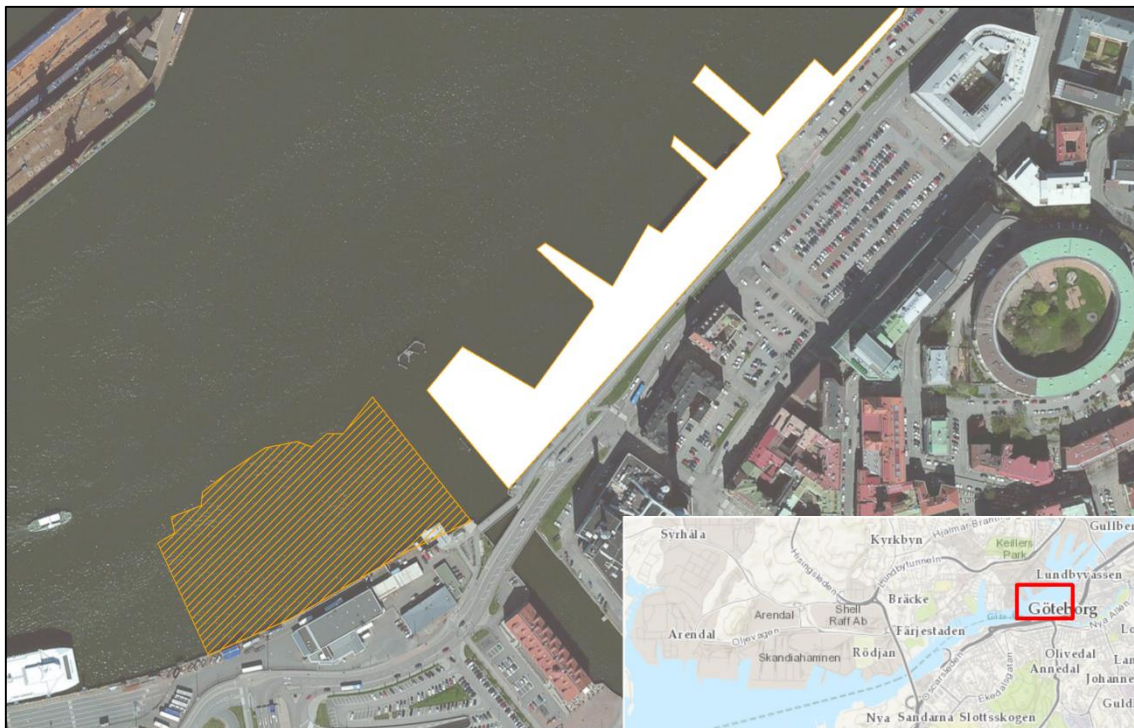
Figur 1 Illustration av de strandlinjer som modellerats. Kalibreringsmodellen utgörs av dagens strandlinje. Nollalternativet utgår ifrån att Skeppsbron är anlagd enligt det vita området. Den nu aktuella utbyggnaden visas i figuren med orange skraffering.
